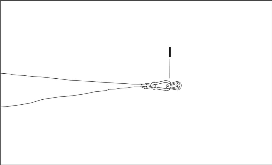
Führen Sie nun das lose Ende des Seils durch die Umlenkrolle am Sonnensegel und dann zurück zur Umlenkrolle am Schieber. Anschließend fädeln Sie das Seil durch die Seilklemme am Oberstock und wickeln es an der Seilklampe am Unterstock auf.
