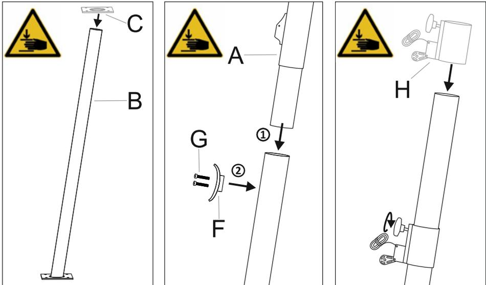
Setzen Sie nun den Mast auf die zuvor montierte Universal-Bodenplatte oder den Universal-Bodenanker und drehen Sie die Schrauben locker ein. Hierzu verwenden Sie die Schrauben M8x25 (D) sowie jeweils eine Unterlegscheibe (E).
