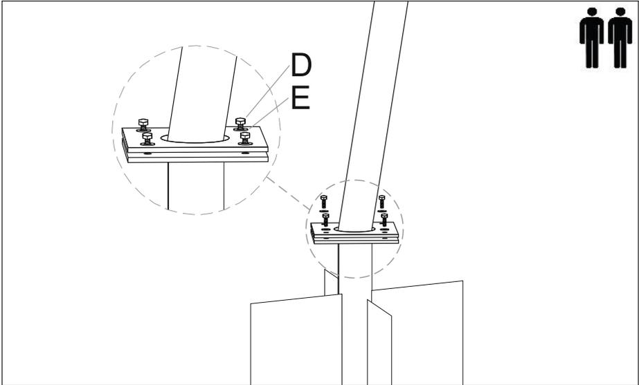
Richten Sie nun den Mast so aus, dass der Mast entgegen der Zugrichtung zur Mitte des Sonnensegels zeigt. Anschließend verschrauben Sie die Klemmplatte fest mit der Universal-Bodenplatte oder dem Universal-Bodenanker.
