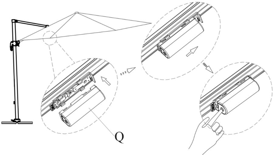
Zum Einschalten der Beleuchtung betätigen Sie einmal kurz den Schalter am Akku. Durch erneutes Drücken wird die Beleuchtung wieder ausgeschaltet.
