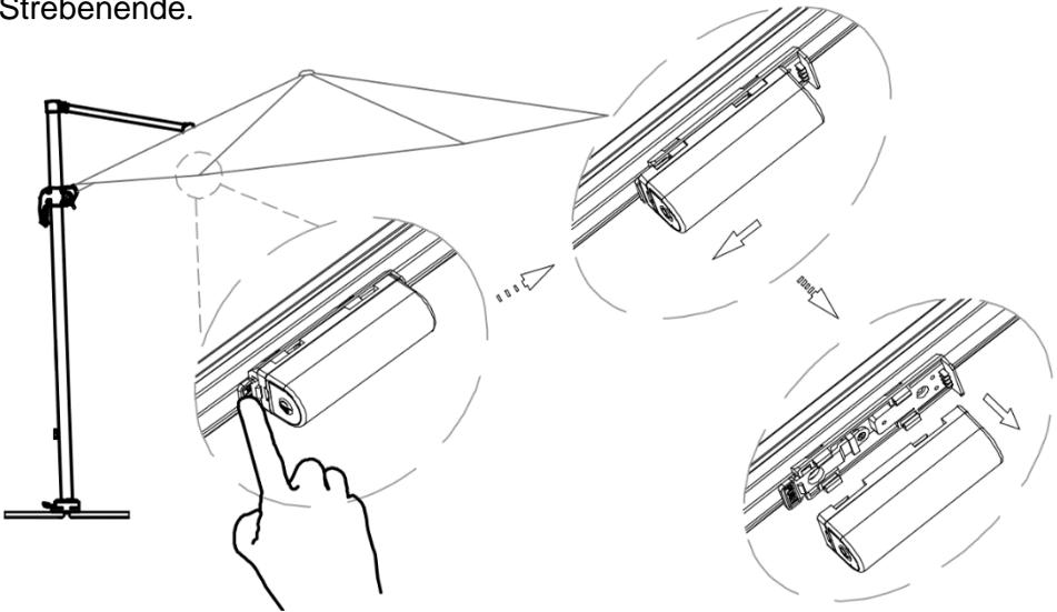
Bei längerem Nichtgebrauch, bzw. nasser Witterung, empfehlen wir den Akku vom Schirm zu entfernen und trocken und frostfrei zu lagern.
