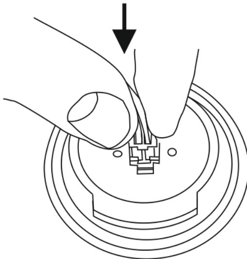
Nun das Kabel in der kleinen Öffnung am Schirm verstauen, den Solar-Top am Schirm aufsetzen und um 90° im Uhrzeigersinn verdrehen.
